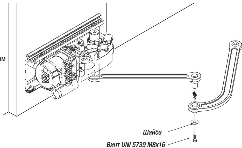
Соедините ведомый рычаг с рычагом передачи.
