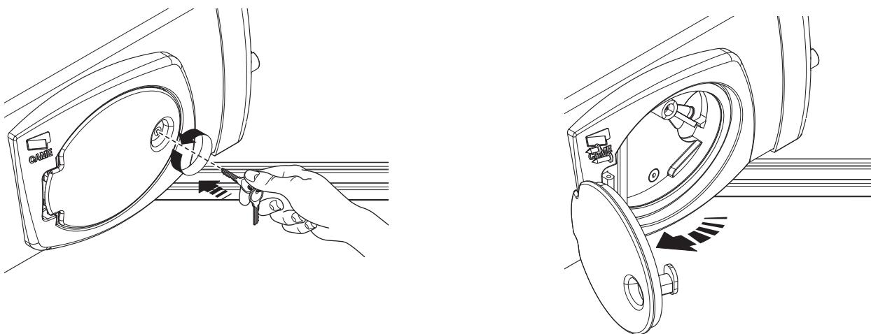
Чтобы разблокировать привод, поверните до упора разблокировочный рычаг по часовой стрелке.
