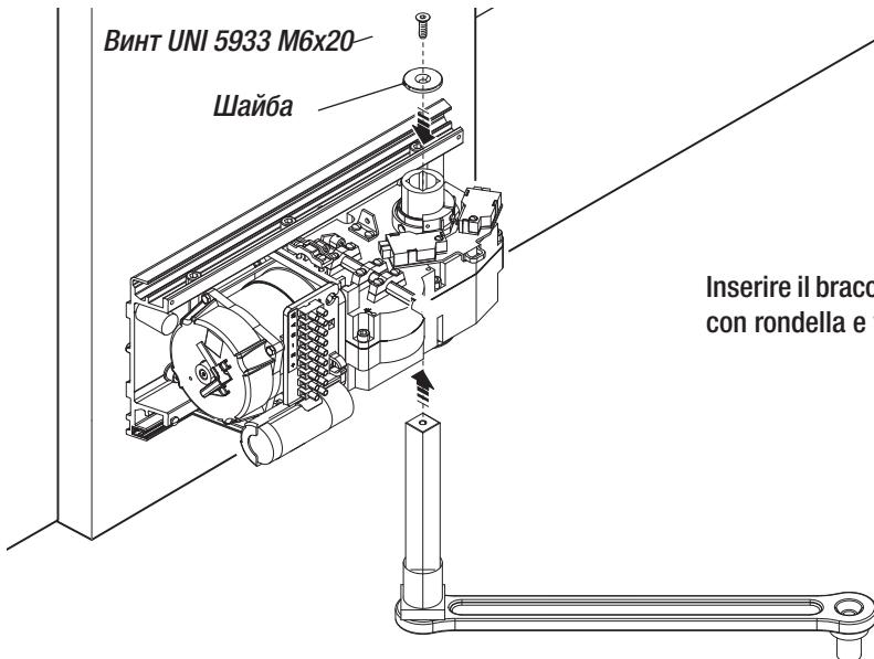
Inserire il braccio di trasmissione nell'albero motore e fissarlo con rondella e vite.
